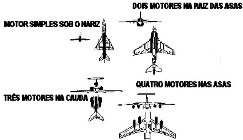
Fig. 3-10 – Tipos de motor de aeronaves a jacto
